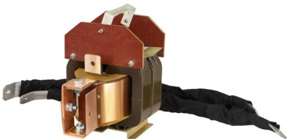
Малогабаритный трансформатор нагрузочный НТ-12 предназначен для испытаний токовых расцепителей автоматических выключателей и релейных защит первичным током до 12 кА при их наладке и проверке. Оптимальная конструкция трансформатора позволяет значительно снизить нагрузку на питающую сеть при получении больших токов, а также создать компактное и относительно легкое устройство.
