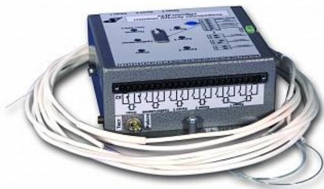
Устройство с волоконно-оптическим датчиком предназначено для фиксации момента возникновения дуги в шкафах комплектных распределительных устройств (КРУ) 6–35 кВ и выдачи сигнала управления в цепи автоматики и релейной защиты.
