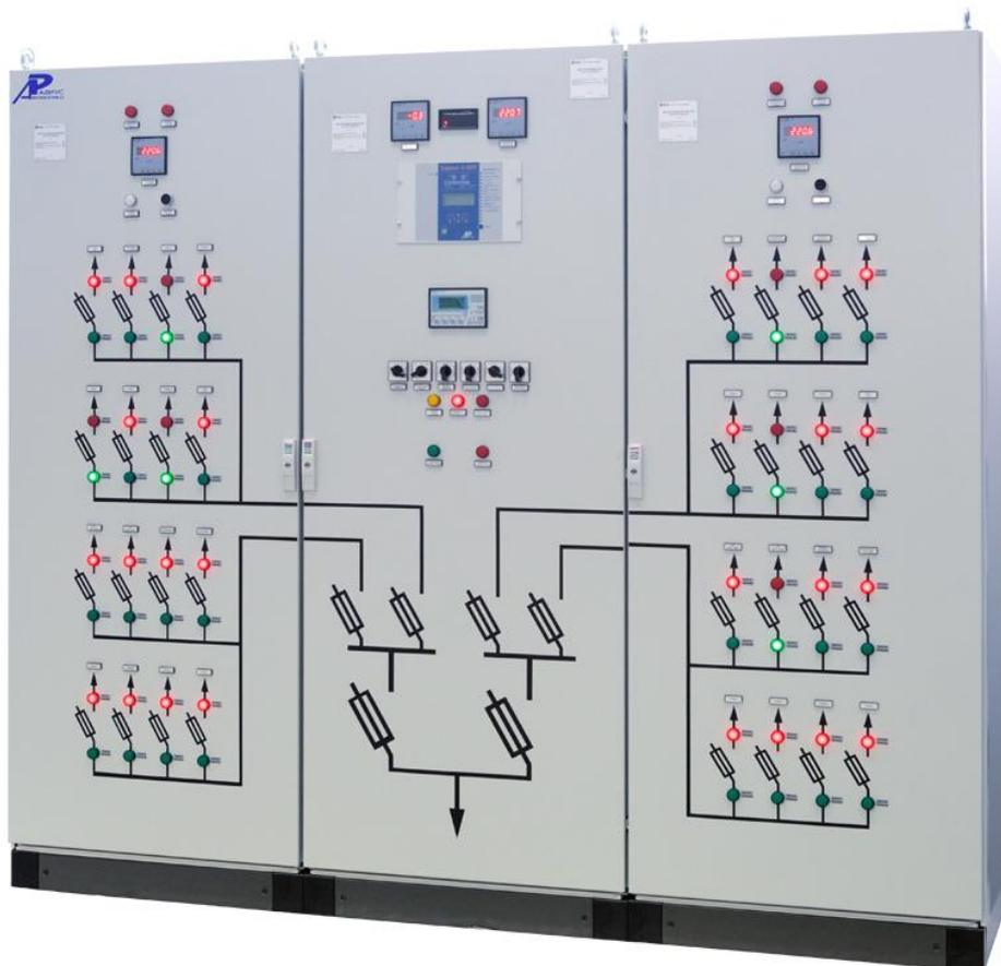
Щиты постоянного тока ЩПТ-РА предназначены для приема электрической энергии от выпрямительных устройств и аккумуляторной батареи и распределения электроэнергии по цепям собственных нужд постоянного тока на электрических станциях и подстанциях.
