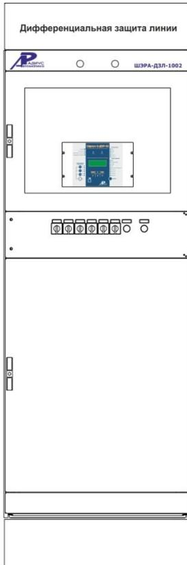
Шкаф дифференциальной защиты линии (для схемы РУ с двумя выключателями на присоединение или с двойной системой шин с обходной) ШЭРА-ДЗЛ-1002 БПВА.656457.284, БПВА.650645.001 ТУ
