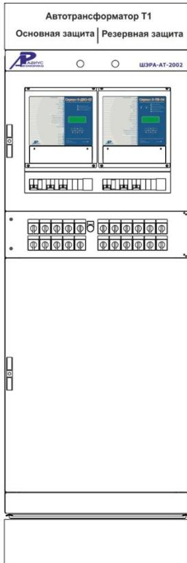
Шкаф основных и резервных защит автотрансформатора и АУВ стороны ВН (для схемы ОРУ ВН с ОВ)
