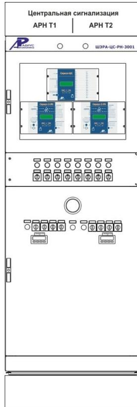
Шкаф центральной сигнализации и регулирования напряжения трансформаторов
