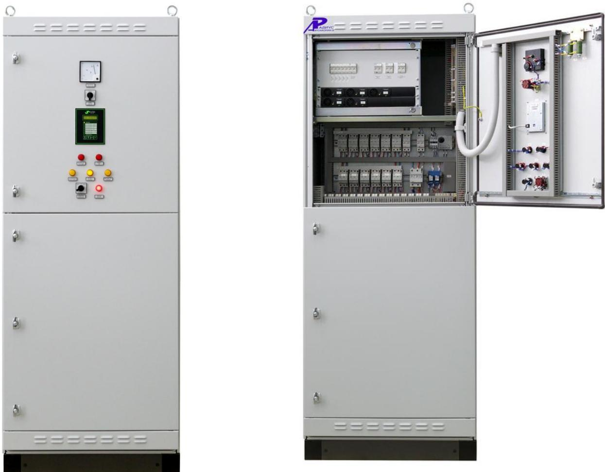
Шкаф оперативного постоянного тока ШОТ-РА предназначен для приёма электроэнергии от аккумуляторной батареи, расположенной в шкафу, поддержания её параметров от двух независимых источников (выпрямительных устройств) и распределения электрической энергии по цепям собственных нужд постоянного тока на понижающих трансформаторных подстанциях с высшим напряжением до 110 кВ для питания оперативных цепей схем релейной защиты и автоматики, а также питания приводов выключателей.
