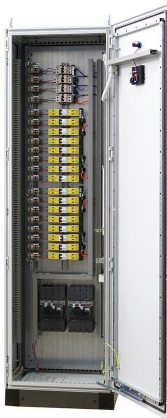
ШРОТ-РА предназначен для приёма электроэнергии от щитов постоянного тока и распределения электрической энергии по цепям собственных нужд постоянного тока на понижающих трансформаторных подстанциях с высшим напряжением до 220 кВ для питания оперативных цепей схем релейной защиты и автоматики, а также питания приводов выключателей. Шкаф устанавливается в помещении релейного щита и РУ 6-10 кВ.
