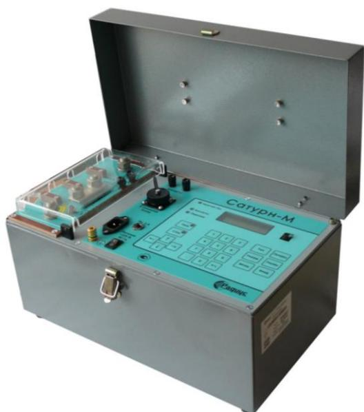
Комплектные испытательные устройства «Сатурн-М» и «Сатурн-М1» предназначены для проверки характеристик автоматических выключателей переменного тока с электро-магнитными и тепловыми расцепителями на местах их установки, а также в лабораториях путем регулировки тока, протекающего через проверяемый автоматический выключатель, измерения времени и действующего значения тока в момент срабатывания автомата.
