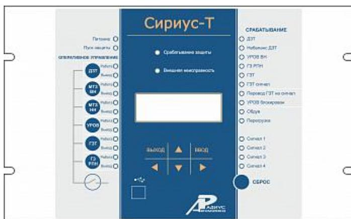
Устройство микропроцессорной защиты «Сириус-Т» предназначено для выполнения функций основной защиты двухобмоточного (в том числе с расщепленной обмоткой) трансформатора с высшим напряжением 35-220 кВ.
