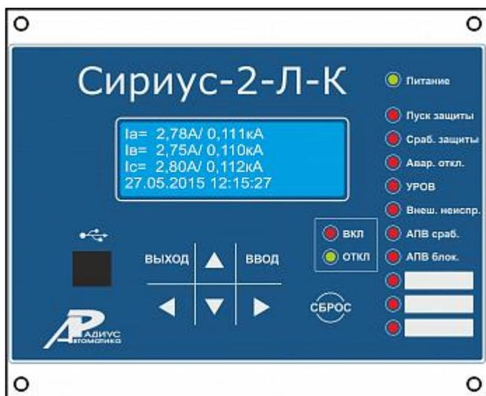
Реле тока «Сириус-2-Л-К» предназначено для выполнения функций релейной защиты, автоматики, управления и сигнализации присоединений напряжением 3–35 кВ. Реле предназначено для защиты воздушных и кабельных линий, вводов, секционных выключателей, а также трансформаторов, преобразовательных агрегатов и т.д. Интеллектуальное реле тока «Сириус-2-Л-К» может применяться при построении высокотехнологичных систем РЗА повышенной экономической эффективности. Функции Реле тока Сириус-2-Л-К
