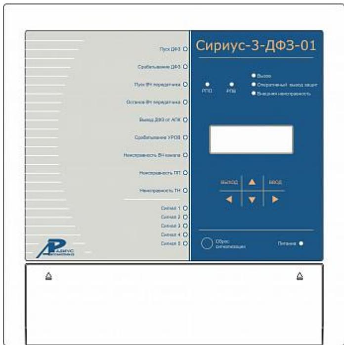
Устройство микропроцессорной защиты «Сириус-3-ДФЗ-01» предназначено для защиты воздушных и кабельных линий 110-220 кВ в сетях с эффективнозаземленной нейтралью. Содержит основную защиту абсолютной селективности. Тип защиты абсолютной селективности – дифференциально-фазная защита (ДФЗ).
