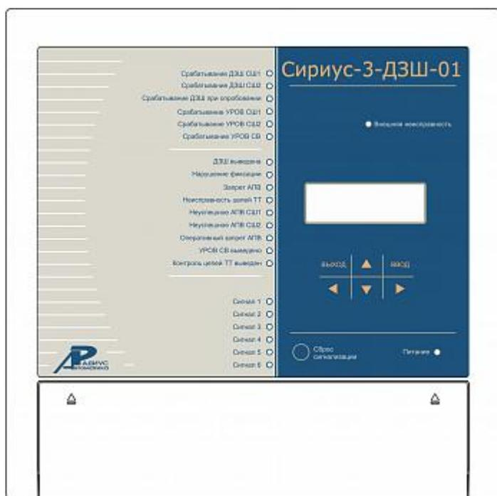
Микропроцессорное устройство защиты «Сириус-3-ДЗШ-01» предназначено для реализации функций основной защиты, автоматики и сигнализации систем сборных шин напряжением 35–220 кВ с фиксированным или изменяемым присоединением элементов, с числом присоединений до 16.
