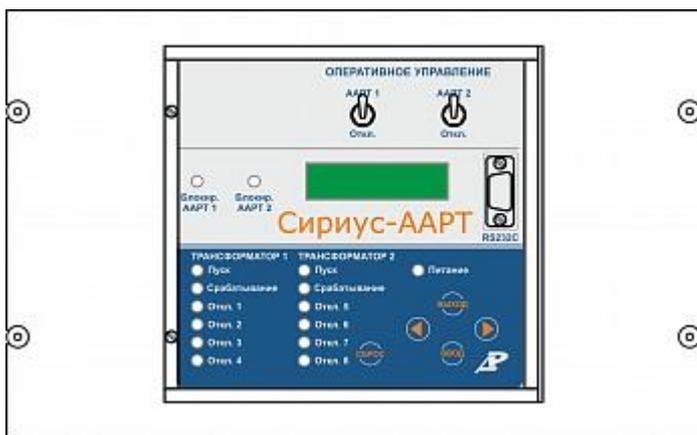
Микропроцессорное устройство автоматической аварийной разгрузки трансформатора «Сириус-ААРТ» предназначено для обеспечения защиты от перегрузки трансформаторов путем автоматического отключения ряда потребителей нагрузки в зависимости от тока с учетом тепловой модели трансформатора.
