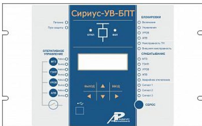
Устройство микропроцессорной защиты «Сириус-УВ» в исполнении «БПТ» предназначено для выполнения функций управления, автоматике и сигнализации высоковольтного выключателя 35, 110 и 220 кВ с трехфазным управлением, а также для выполнения функций резервных защит силового трансформатора или подменных защит воз-душной линии. Содержит ступенчатые защиты относительной селективности и функции автоматике.
