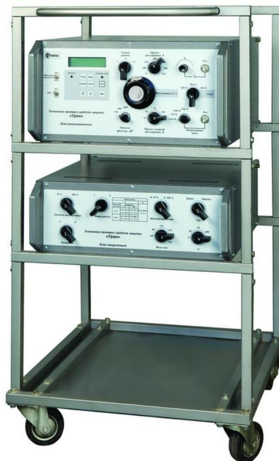
Установки предназначены для проверки электрических и временных характеристик про-стых («Уран-1») и сложных («Уран-2») средств релейной защиты и автоматики. Они позволяют заменить установки ЭУ5000 и ЭУ5001 и их модификации.
