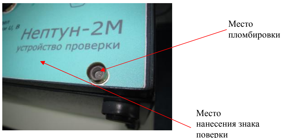
Рисунок 2 - Место пломбировки от несанкционированного доступа и нанесения знака поверки
